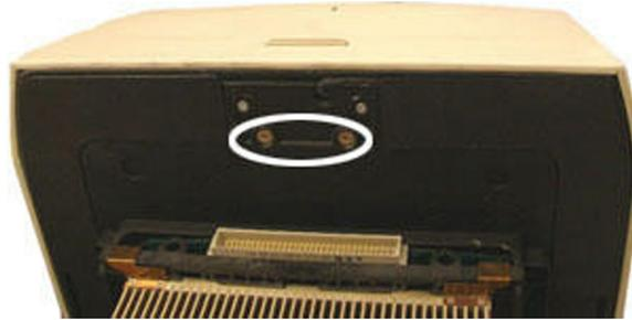
**Figura 86. Retire estes parafusos para desbloquear o módulo óptico.**
